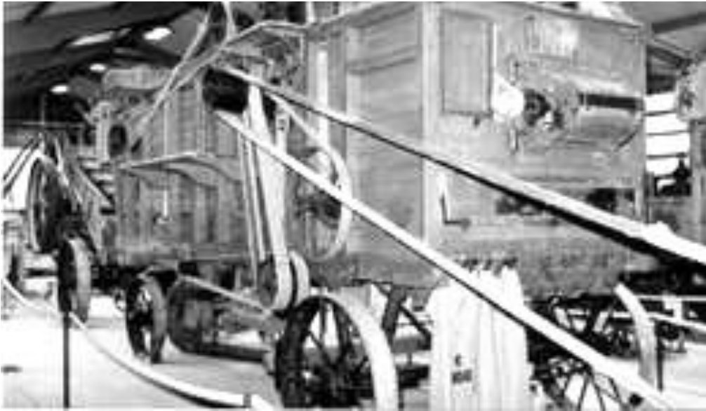
Batteuse Merlin : transmissions par courroies
