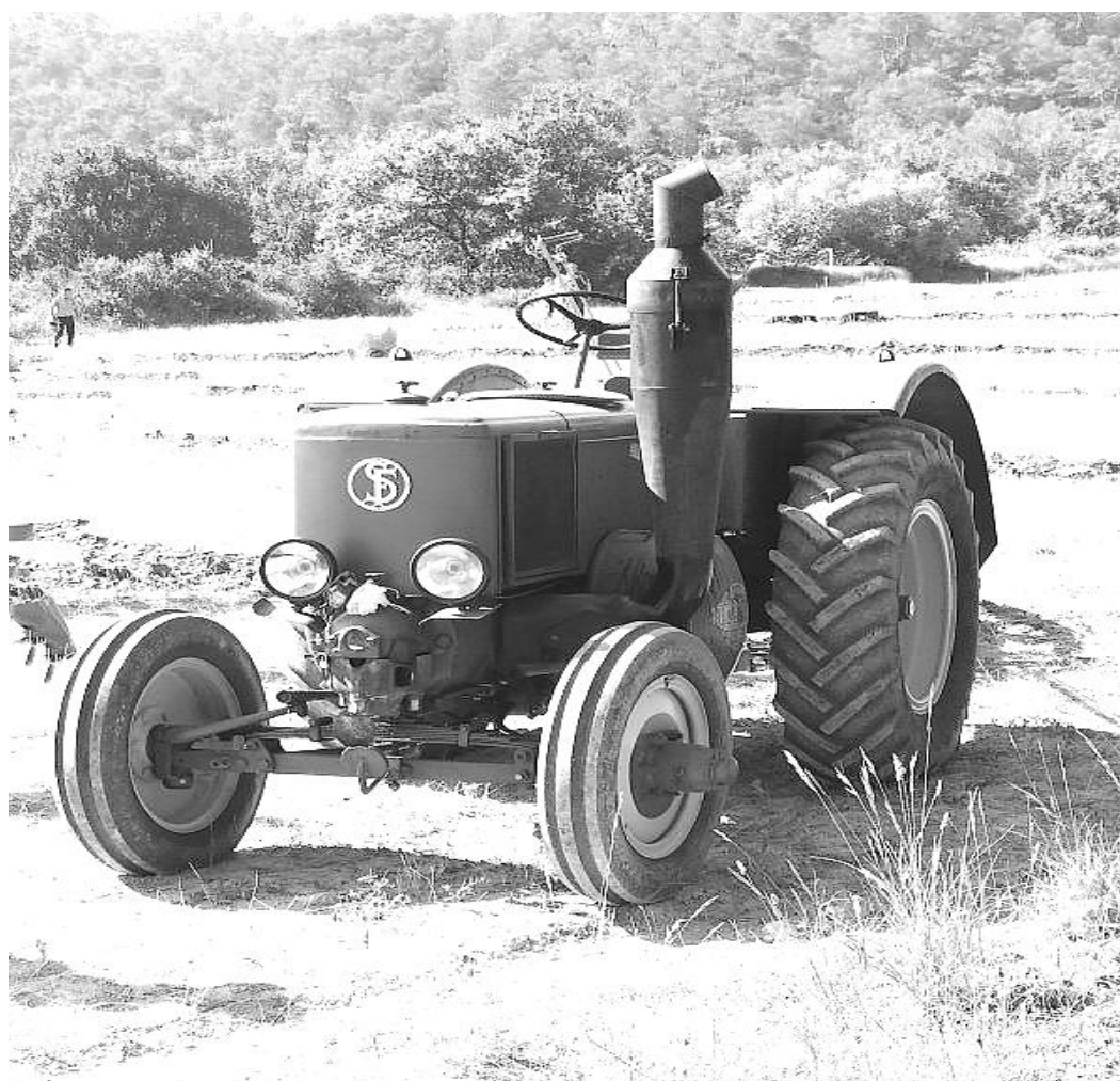
Les tracteurs Robust, Lanz et Société Française qui remplacèrent les locomobiles. Il fallait les chauffer au chalumeau avant mise en marche du moteur
